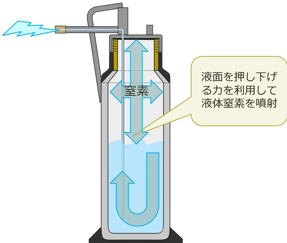
4. 引き金を引くことで、開放された噴射口に向かって気圧の力で液体窒素が吹き出します。
