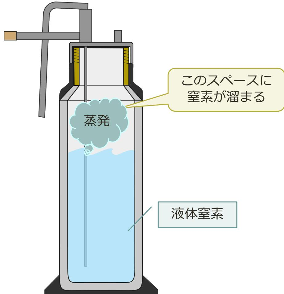
◆ クライオプロは、液体窒素がボトル内部で蒸発して発生する**蒸気圧を利用して噴射**しています。
