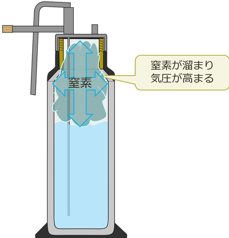
3. ボトル内部の気圧が充分に高まると、液体窒素の液面を押し下げる力がはたらきます。
